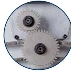
▶ Vier weitere Geschwindigkeiten durch Wechselgetriebe
