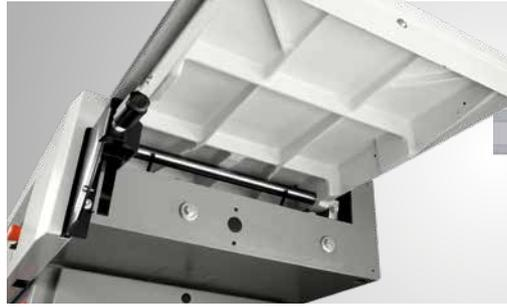
▶ Die Abrichttische aus einer stark verrippten Gusskonstruktion bleiben dauerhaft plan und präzise
