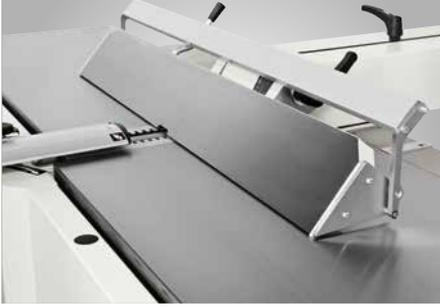
▶ Dank der breiten Auflagefläche erlaubt der aus geschliffenem Gußeisen bestehende Fügeanschlag die Präzisionsbearbeitung von großen und schweren Werkstücken. Der Seitenanschlag ist stufenlos bis auf 45° schwenkbar.
