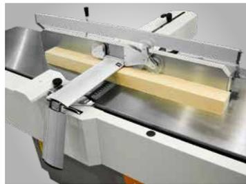
▶ Die Vorspannung drückt den Schutz gegen das Werkstück
