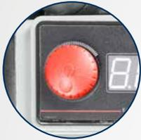
▶ Vorschubgeschwindigkeit stufenlos wählbar von 2 – 22 m/min
